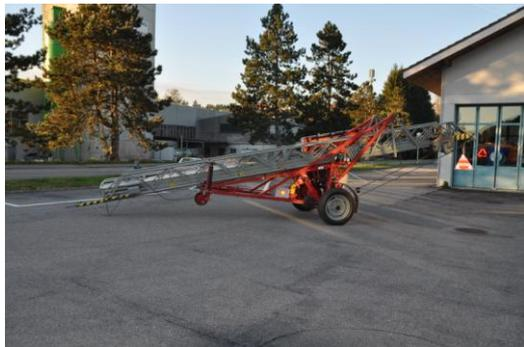
ALM-22 (Anhängeleiter motorisiert 22 Meter) einen Wankelmotor. Der Sachsmotor KM 48, System NSU/Wankel, ist eine bewährte Konstruktion. 1960 lief bei Fichtel & Sachs AG in Schweinfurt der erste Motor dieses Typs vom Band, produziert bis etwa 1976. Gestartet wird der Motor per Handzug. Die Leiter kann aber auch mechanisch ohne Motorantrieb aus- und eingefahren werden.
